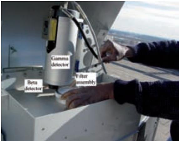
Figure 8 : précision de la mesure maximisée par l'installation géométrique des détecteurs et du filtre à air. L'ensemble détecteur pivote vers l'extérieur (comme indiqué) lors du changement de filtre
