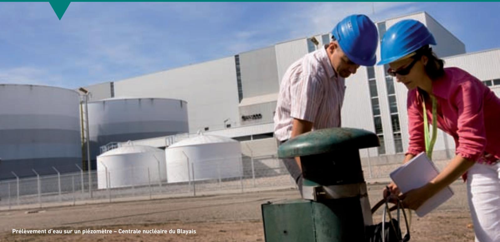
Prélèvement d'eau sur un piézomètre – Centrale nucléaire du Blayais
