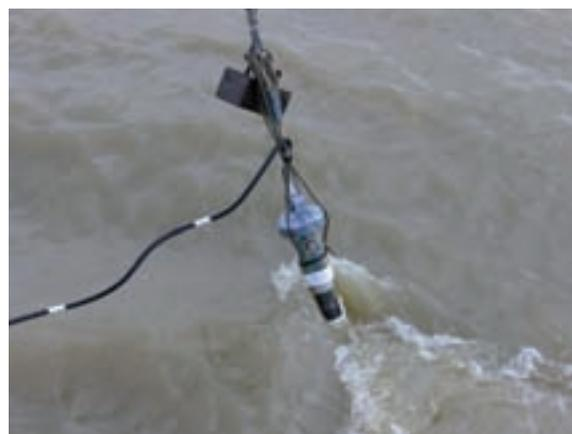
Figure 3 : syst me de d tection mobile "T l hydro" d di    des constats radiologiques ponctuels (mesures en aval de rejets hospitaliers, intervention en situation de crise...)
