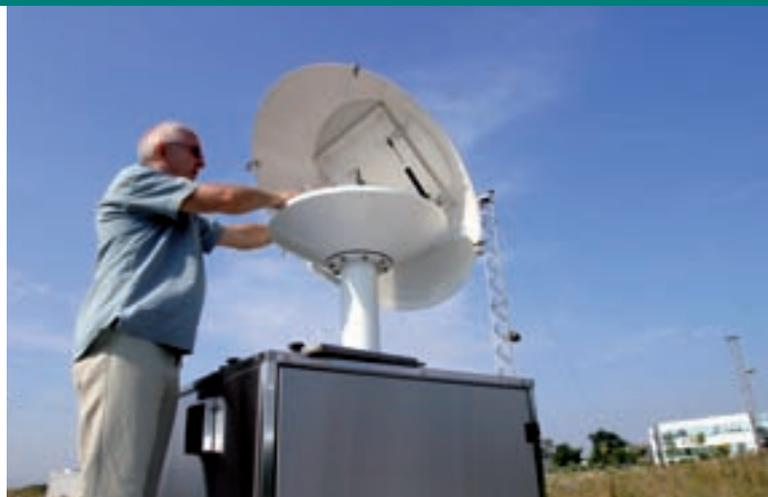
Station d'aérosols – Prélèvement d'aérosols atmosphériques sur un filtre (500 m<sup>3</sup>/heure)
