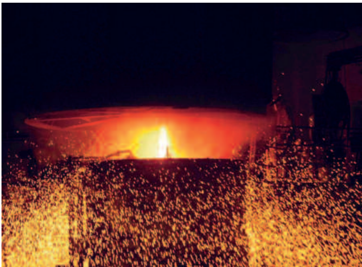
Coulée d'acier destinée à une plaque tubulaire de générateur de vapeur chez le forgeron ISW, Muroran, Japon
