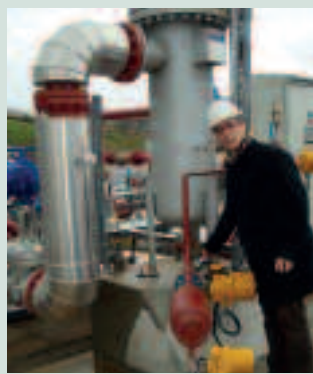
Florent Matouk mesure avec un AD6 de Saphymo les débits de dose liés aux dépôts naturellement radioactifs d'un site géothermique de Soultz - Décembre 2008
