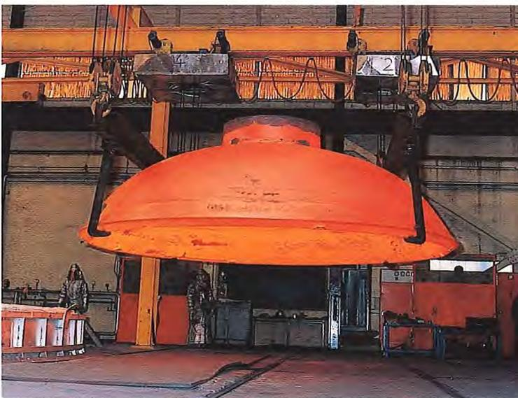
Fluotournage d'un dôme de générateur de vapeur
