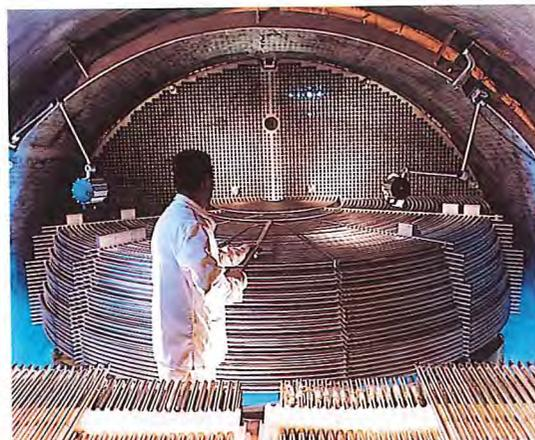
Opération de tubage d'un générateur de vapeur à l'usine Framatome de Chalon
