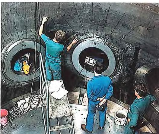
Opération de contrôle d'une cuve de réacteur à l'usine Framatome de Chalon/Saint-Marcel
