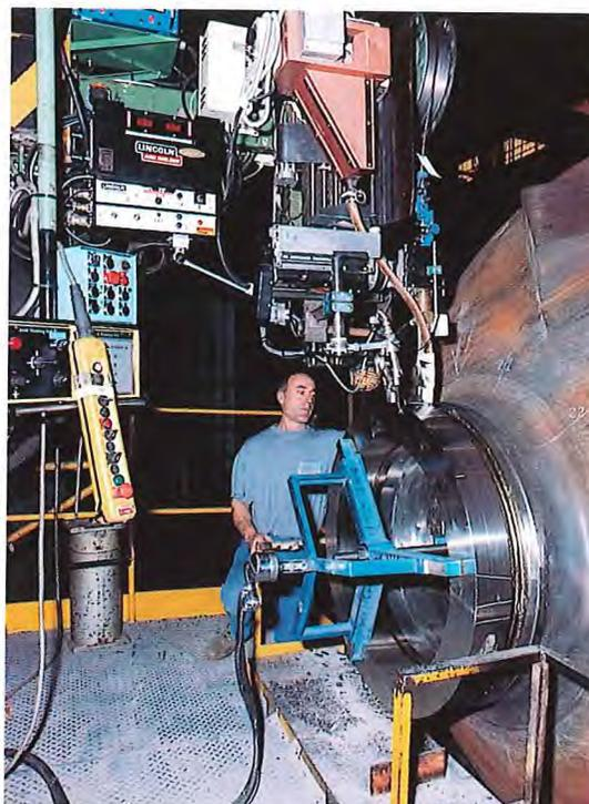
Opération de soudage d'un embout de cuve
