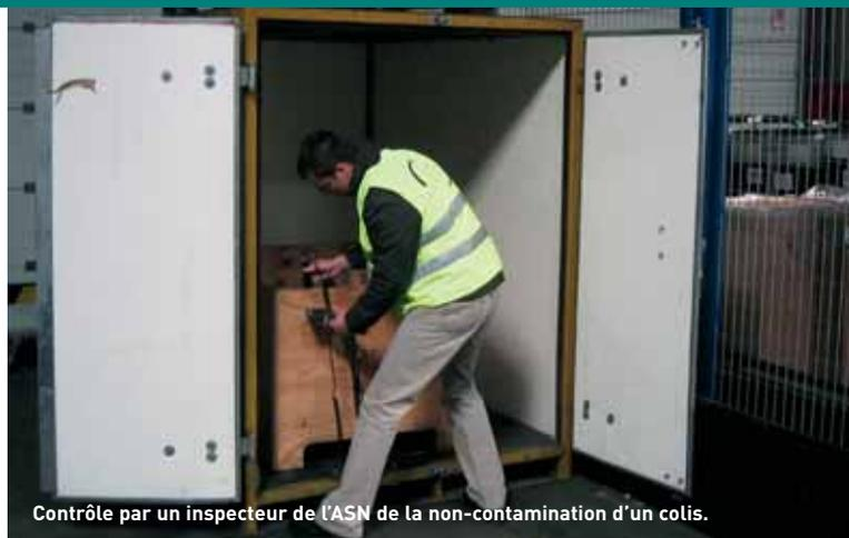
Contrôle par un inspecteur de l'ASN de la non-contamination d'un colis.
