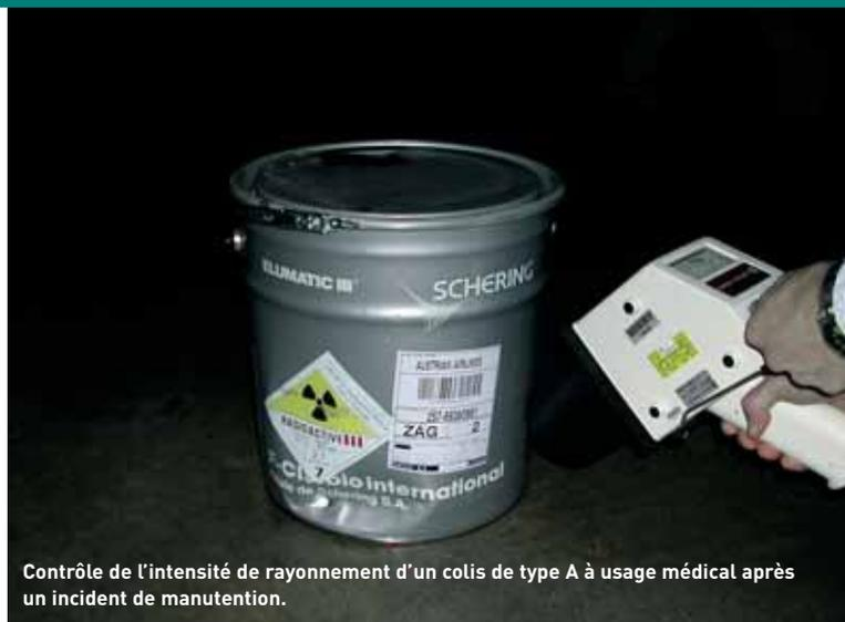
Contrôle de l'intensité de rayonnement d'un colis de type A à usage médical après un incident de manutention.
