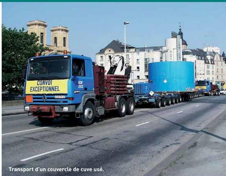
Transport d'un couvercle de cuve usé.
