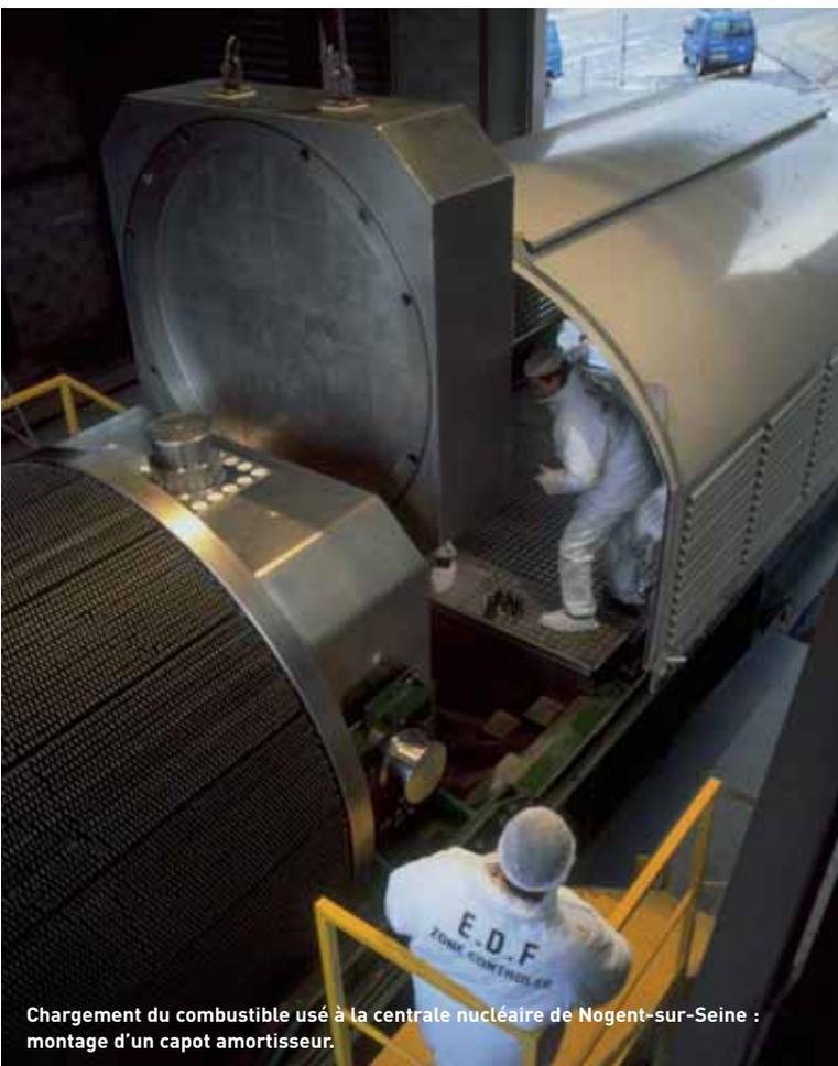
Chargement du combustible usé à la centrale nucléaire de Nogent-sur-Seine : montage d'un capot amortisseur.
