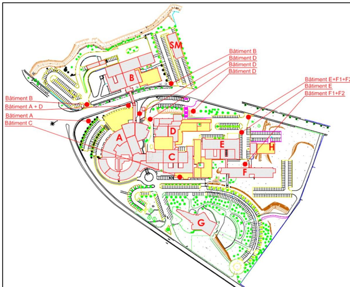
Figure 13: Points de rejets des effluents de l'ICM
