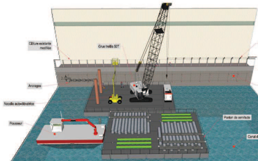
Figure 6 : Atelier nautique dans le canal d'amenée.
