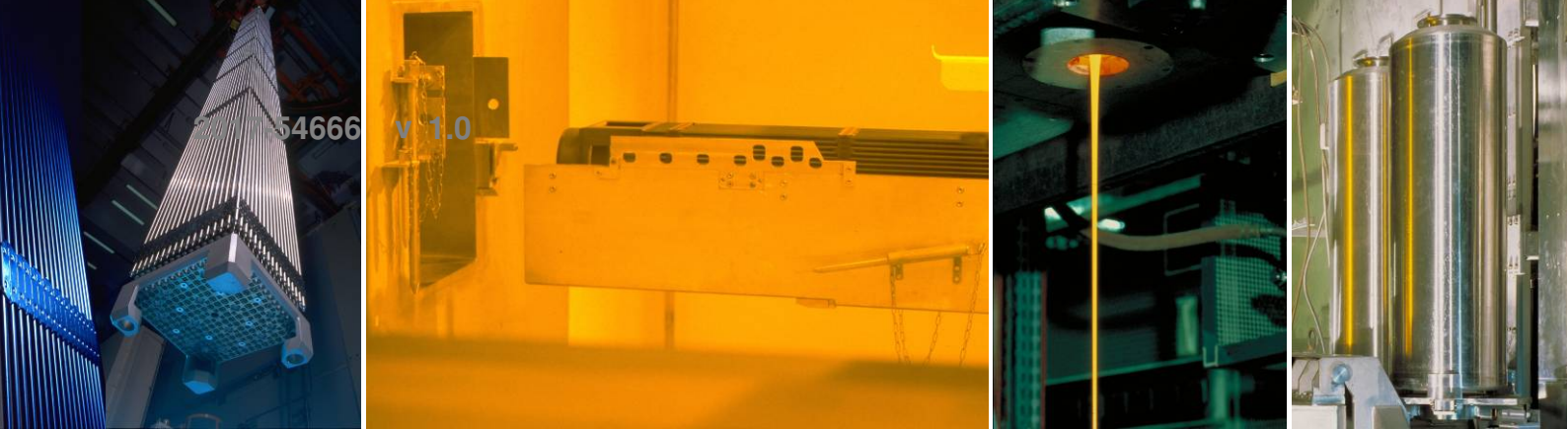
De gauche à droite : combustible neuf, combustible entrant dans la chambre de cisailage, coulée en cellule de vitrification, conteneurs de déchets vitrifiés
