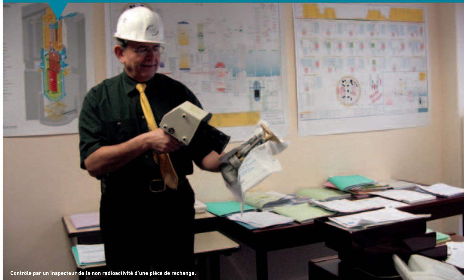
Contrôle par un inspecteur de la non radioactivité d'une pièce de rechange.
