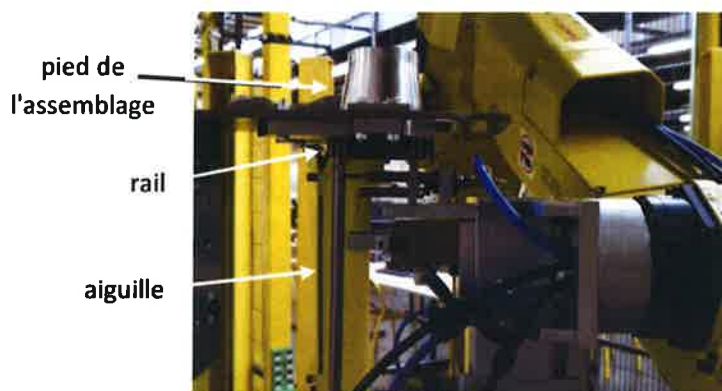
Figure 14 : étude sur la robotisation du montage d'une aiguille sur le pied de l'assemblage
