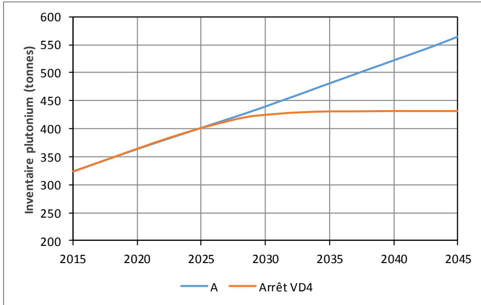
Figure 25 : Evolution de l’inventaire plutonium dans les réacteurs et les installations du cycle entre scénario A et arrêt du parc à VD4
