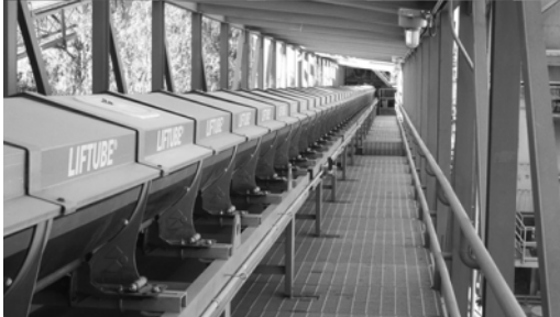
Illustration d'un convoyeur capoté. Système breveté LIFTUBE®
