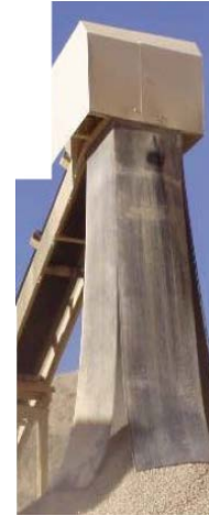
Système flexible de réduction des poussières en bout de bande transporteuse
