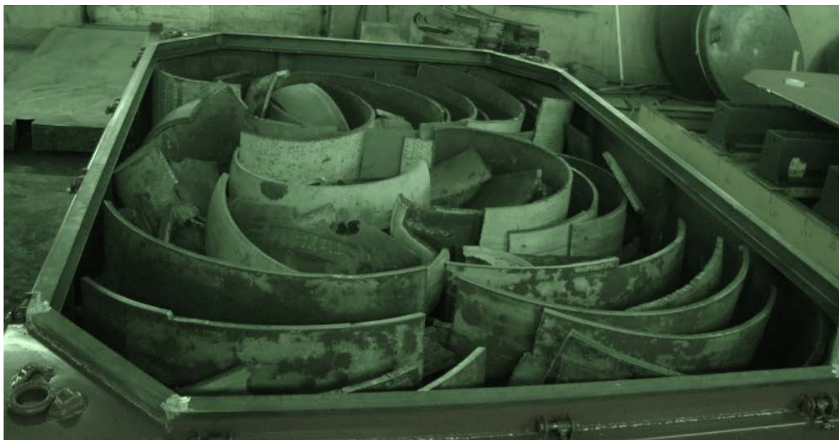
Figure 22 : Remplissage d'un caisson d'un mix de cylindres 48Y et 30B (avant fermeture et injection)
