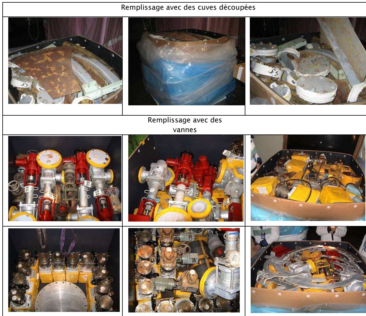
Figure 23 : exemple de conditionnement de déchets métalliques en GRVS renforcés
