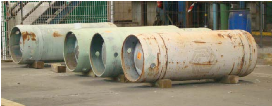
Figure 17 : Cylindre d'UF 6 - Type 30B
