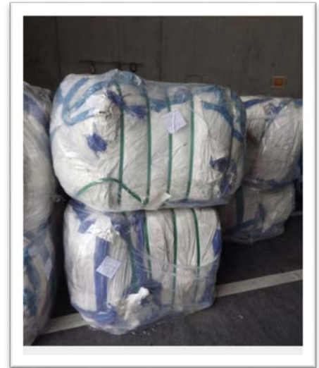
Figure 4 : Big-bags après compactage et confinement dans une enveloppe vinyle thermo-soudée.
