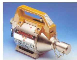
Un appareil de gammagraphie industrielle (utilisé par exemple sur les chantiers)
