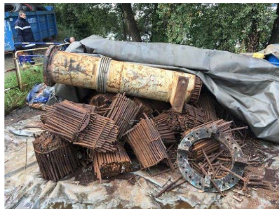
Echangeur thermique contaminé au thorium, retrouvé sur un site de collecte de ferrailles au port de Strasbourg
