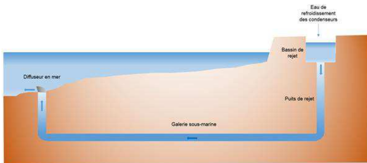
Figure 2.s : Schéma simplifié d'un ouvrage de rejet en mer
