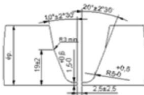
Figure 48 : Chanfrein en U retenu pour la maquette TIG orbital
