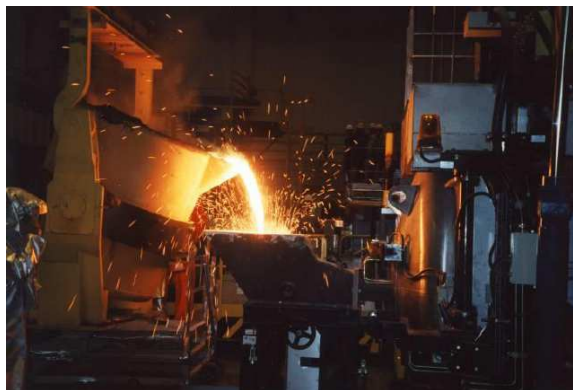
Figure 10 : Fabrication de protections biologiques - Centraco
