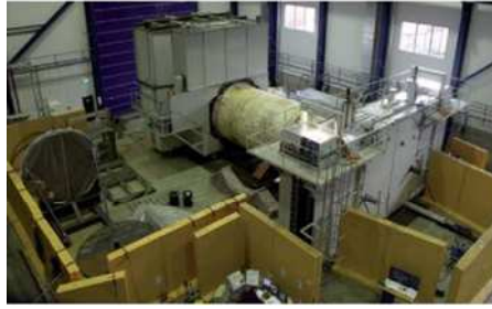
Figure 14 : Traitement d'un GV dans l'installation de Studsvik en Suède
